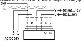
BACnet MS/TP / Modbus RTU
