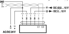
BACnet MS/TP / Modbus RTU
