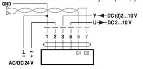
BACnet MS/TP / Modbus RTU
