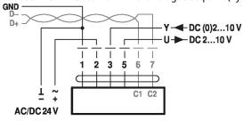
BACnet MS/TP / Modbus RTU
