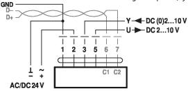
BACnet MS/TP / Modbus RTU
